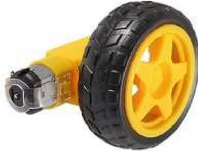
➤ **Alimenter le moteur** avec une tension maîtrisée (qui n'excèdera pas la tension maxi que peut supporter le moteur). On peut utiliser des piles ou bien une alimentation stabilisée (demander au professeur).
