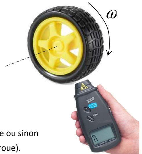
➤ **Utiliser un tachymètre** pour mesurer la vitesse de rotation.
